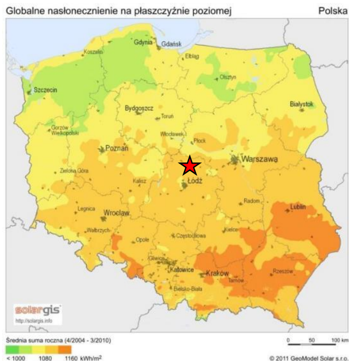
Ryc. 8 Podział Polski na strefy pod względem nasłonecznienia. Orientacyjną lokalizację projektu planu oznaczono gwiazdką (źródło: solargis)
