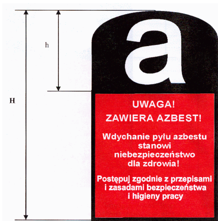
Rys. 5. Wzór oznakowania dróg utwardzonych odpadami zawierającymi azbest ( H = \text{min. } 30 \text{ cm} ).
