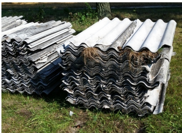
Rys. 2. Złożone faliste płyty azbestowo-cementowe ( źródło: materiały własne )
